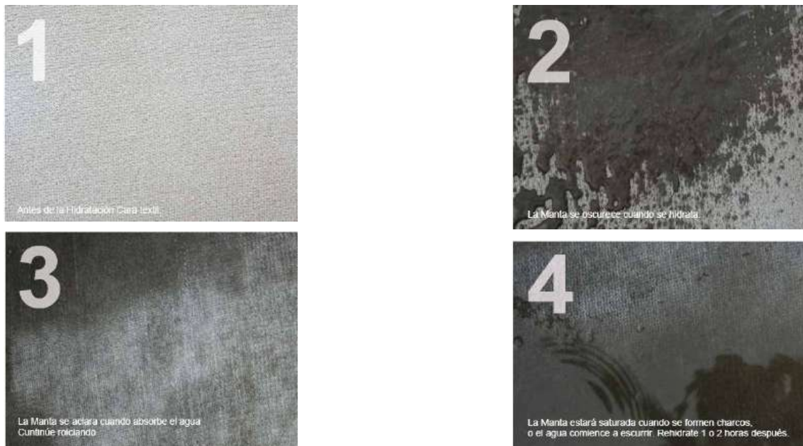
Figura 21 – Secuencia de hidratación de manta de hormigón
