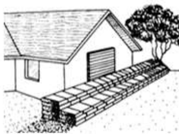
Figura 8 - Modo de acomodar los sacos de arena (escalones de 2 en 2)
