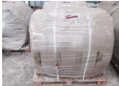
Figura 5 – Acopio de rollos Bulk de manta de hormigón
