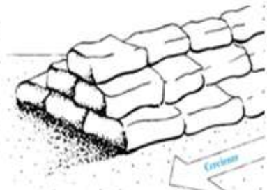
Figura 9 - Modo de acomodar los sacos de arena (escalones de 2 en 2)
